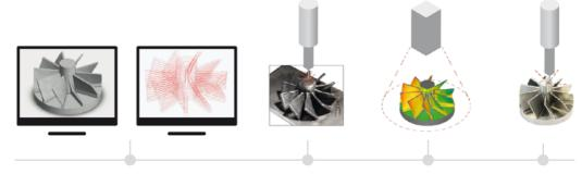
Überarbeitung / Erstellung der CAD- bzw. CAM-Modelle Drucken des Rohlings 3D-Scan / Geometrievermesserung Fräsen des Fertigteils
